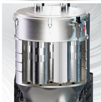
FILTRAZIONE 8 filtri a cartuccia HEPA + PTFE conduttivi
